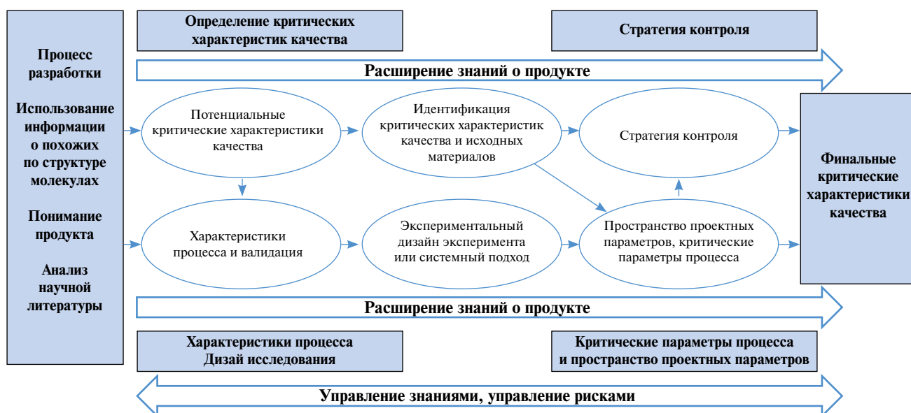
Рис. 1. Алгоритм разработки готового фармацевтического продукта
