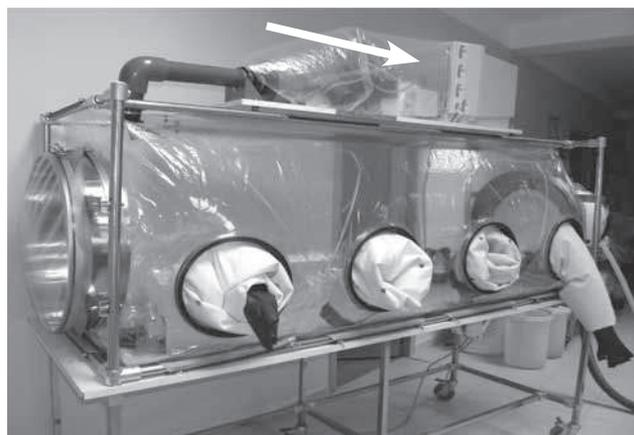
Рис. 2. Усовершенствованная система стерилизации поступающего в изолятор воздуха с применением установки «Поток Интер» (показана стрелкой)
