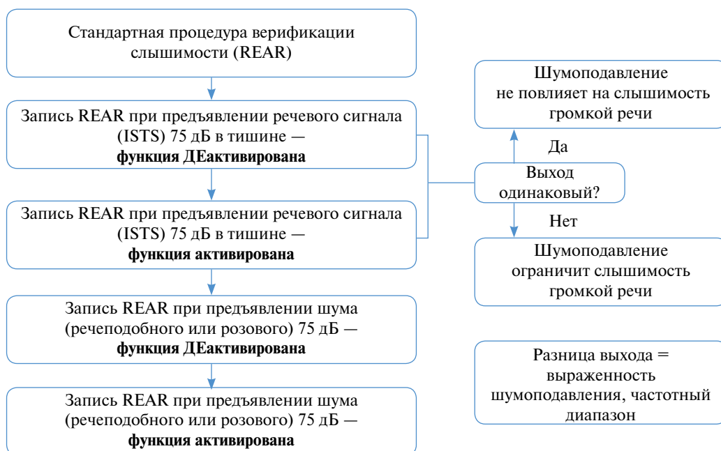
Рис. 2. Алгоритм верификации функции цифрового шумоподавления (Scollie S. и соавт., 2016)
