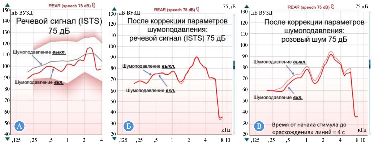
Рис. 3. Верификация функции цифрового шумоподавления: А — активация функции в ответ на громкий речевой стимул (неадекватное функционирование); Б — после коррекции настройки шумоподавление не включается в ответ на громкий речевой стимул; В — шумоподавление активируется в ответ на шумовой сигнал, ограничение усиления происходит преимущественно в низкочастотном диапазоне
